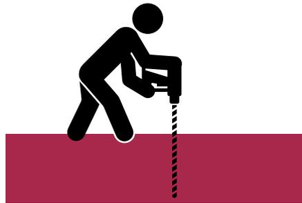
L'avant trou mécanique peut être réalisé à l'aide d'un **marteau perforateur burineur**. Adaptez le diamètre
