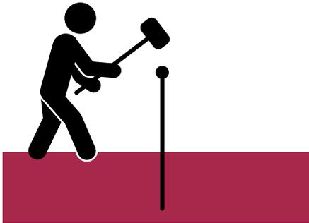
L'avant trou manuel peut être réalisé à l'aide d'une **barre à mine**
